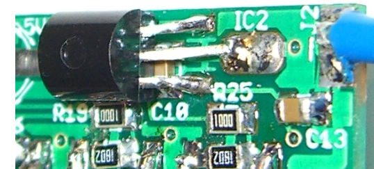
Bedrahteter Spannungsregler, falls in SMD nicht verfügbar
