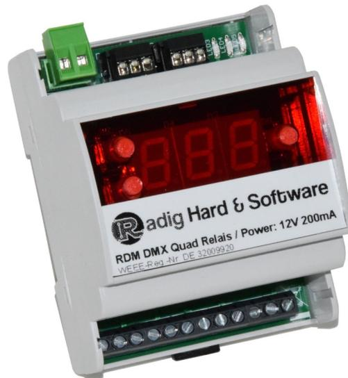
Mit dem RDM DMX Quad Relais können diverse Verbraucher geschaltet werden. Jedem Relais ist ein DMX Kanal zugeordnet, ist der DMX Wert größer als 50% wird das Relais geschaltet. Die Adresseinstellung erfolgt entweder bequem über das große 7 Segment Display, oder über RDM.
