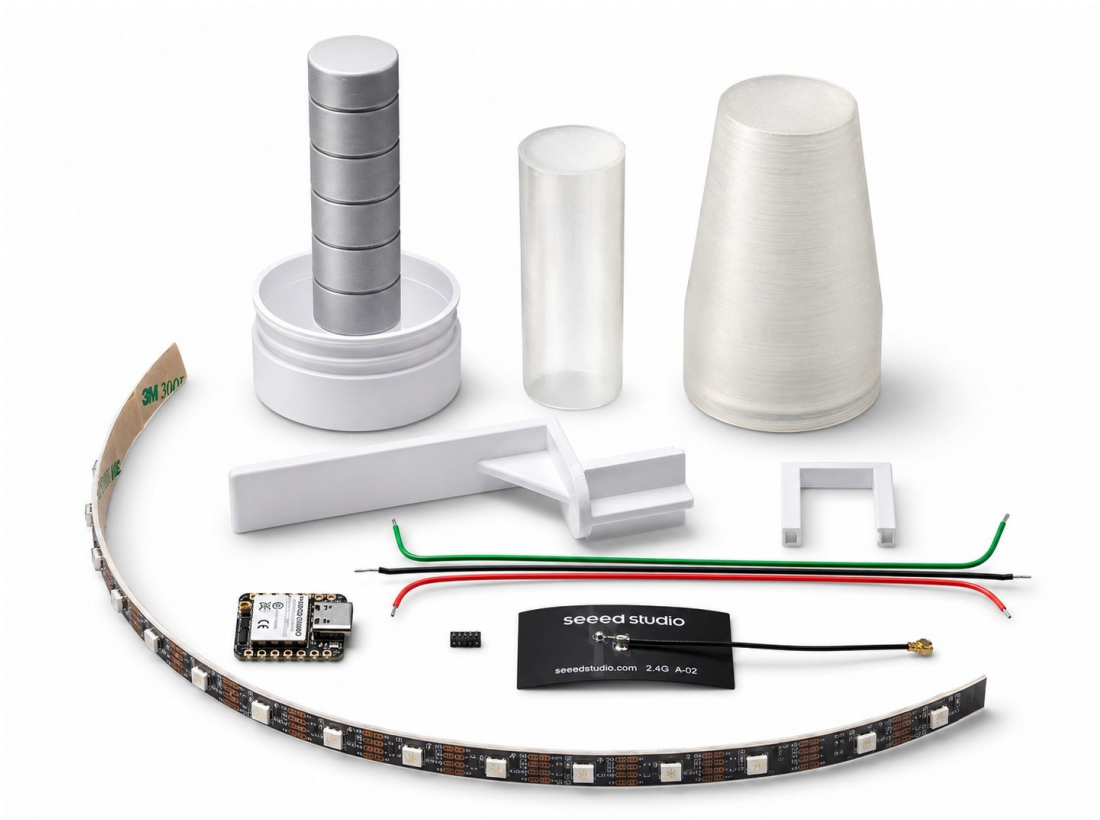
Abbildung 1: Einzelteile des StatusLight.
