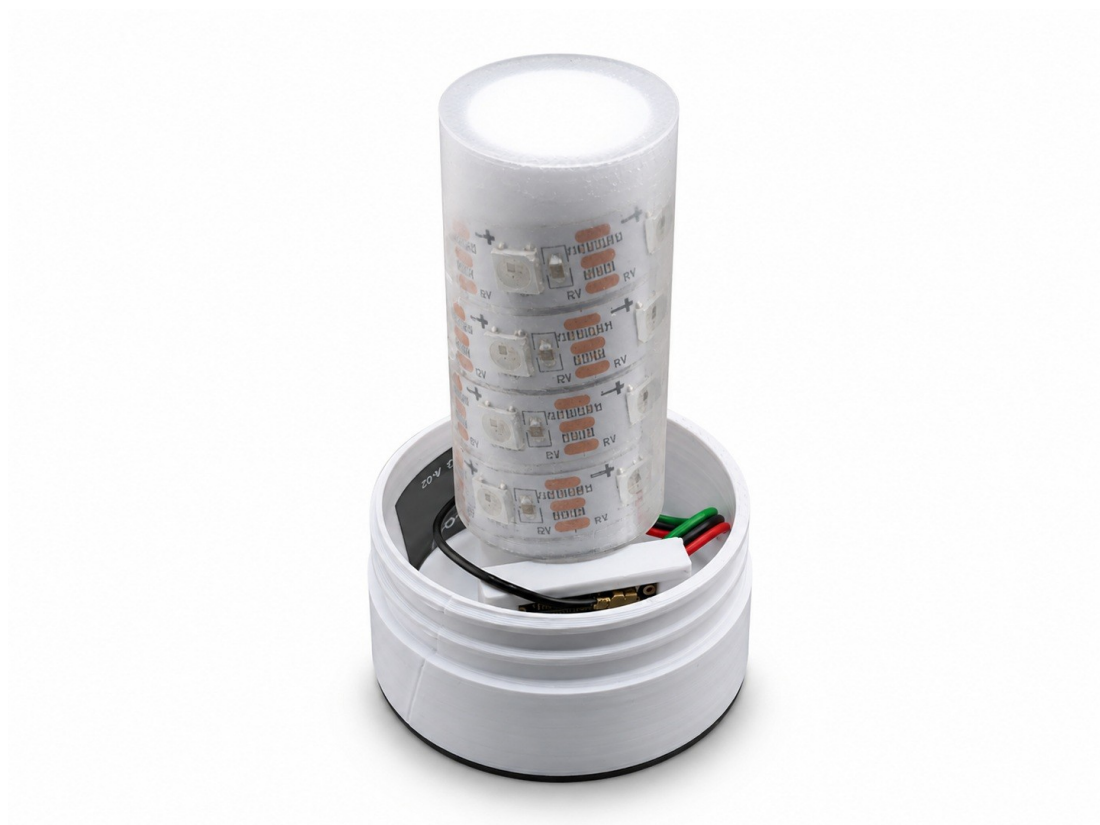
Abbildung 9: LED-Streifen um den inneren Träger.
