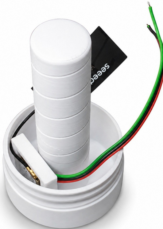
Abbildung 5: Grundkörper mit eingesetztem Modul.
