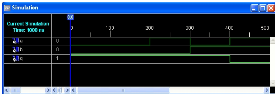
Abbildung 6: Simulation eines Nor-Gatters
