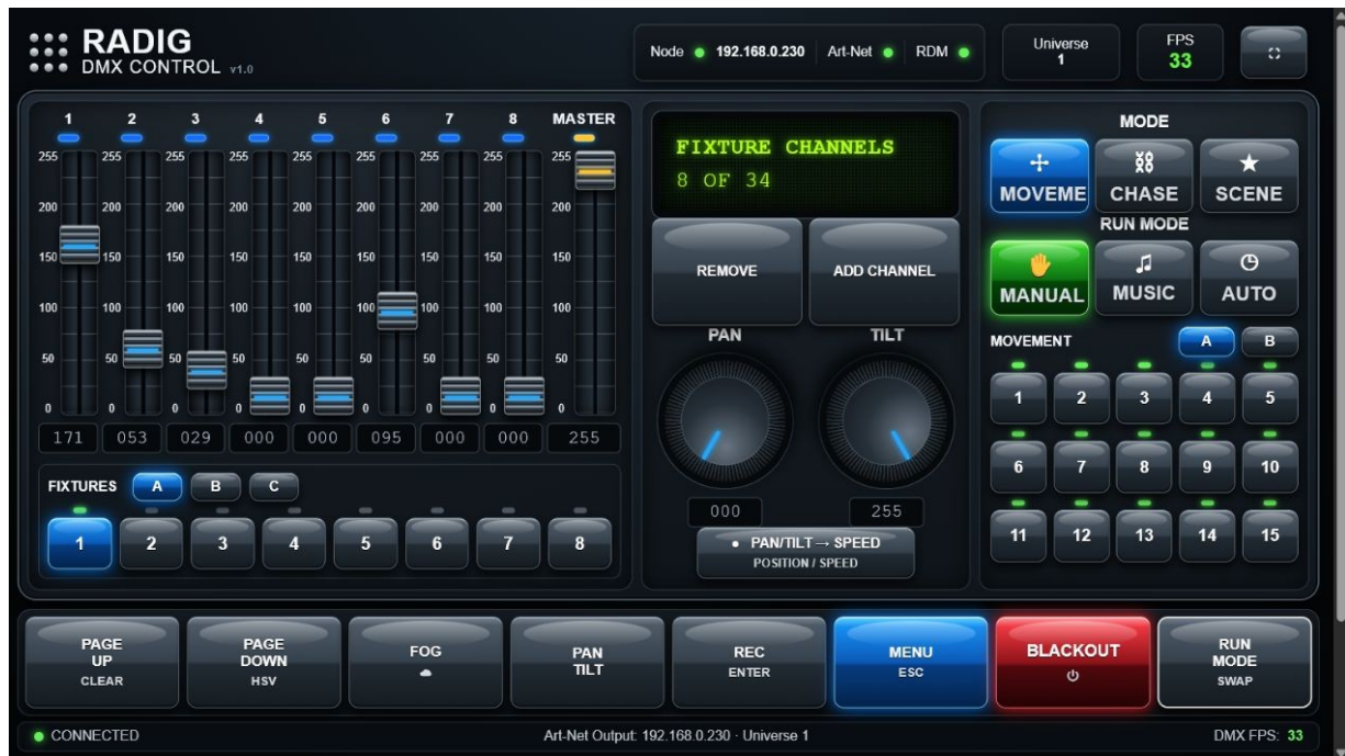
Abb. 3: Kanalanzahl eines Fixtures bis maximal 34 erweitern.
