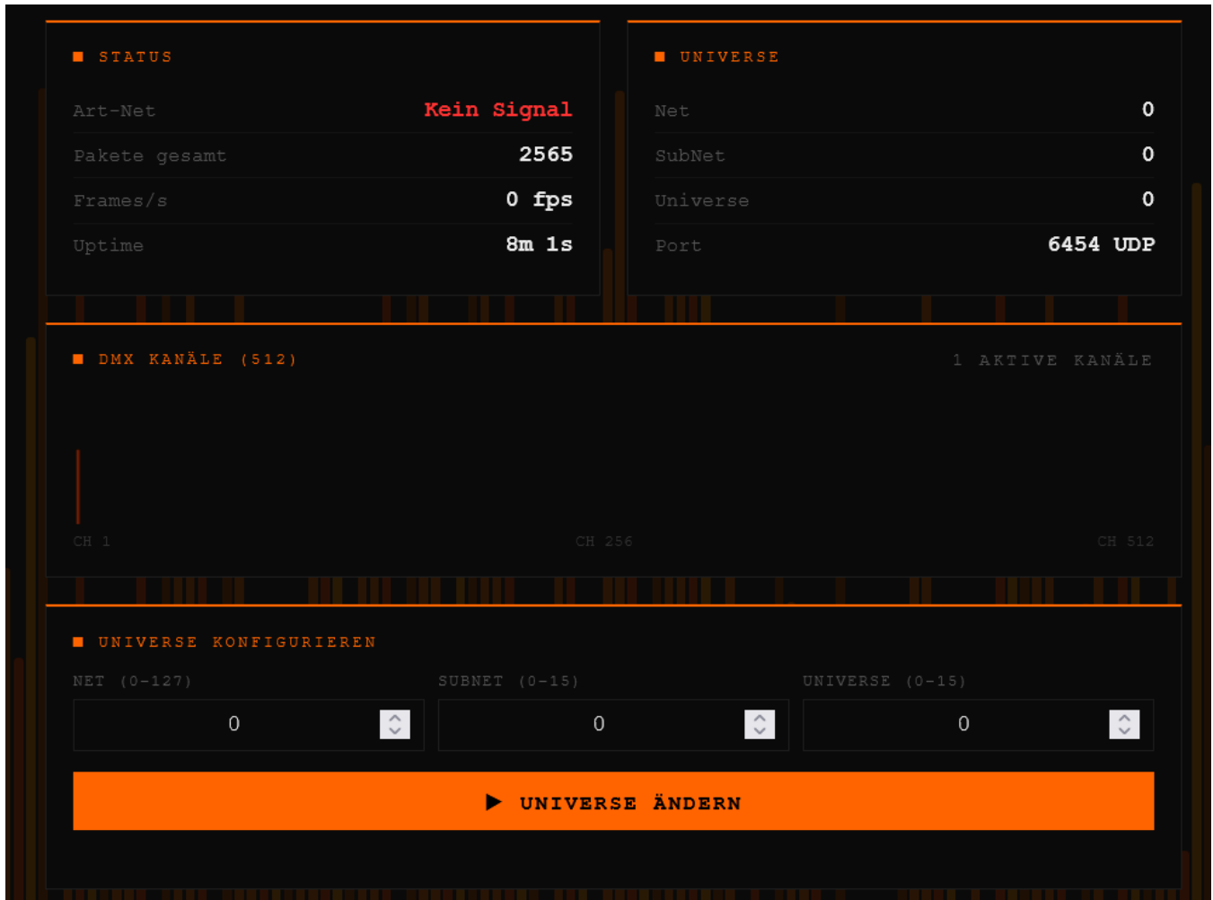
Webinterface des Art-Net Nodes im Browser – Statusanzeige, DMX-Kanalbalken und Universe-Konfiguration
