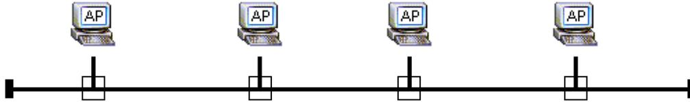
Die Bustopologie wird bei kleinen Netzwerken verwendet. Alle Stationen inklusive Server werden über ein Kabel, dem Bus angeschlossen der an beiden Enden mit Abschlusswiderständen versehen sein muss. Hier wird meist Koaxialkabel verwendet. Das verwendete Koaxialkabel wird mit Hilfe von T Stücken zu einen Bus verbunden.
